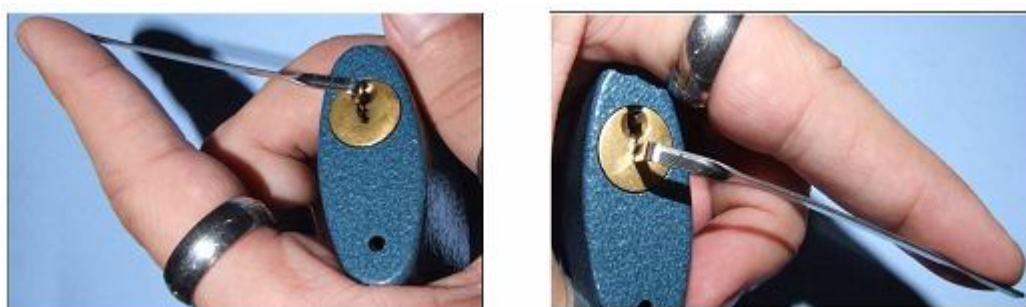
Obr.30: Ukázka vyhmatání zámku – Peking[18]
