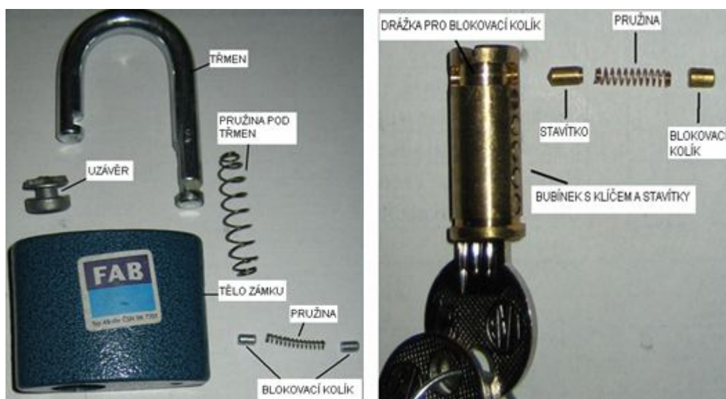
Obr. 19: Rozebraný visací zámek[18]
