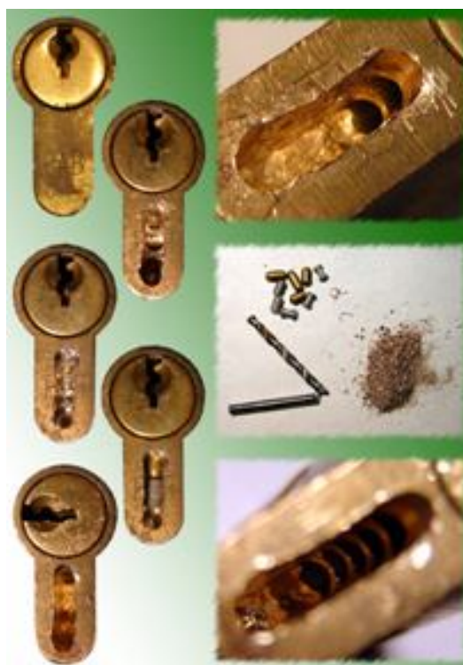
Obr. 14: Odvrtání stavítkového kanálku
