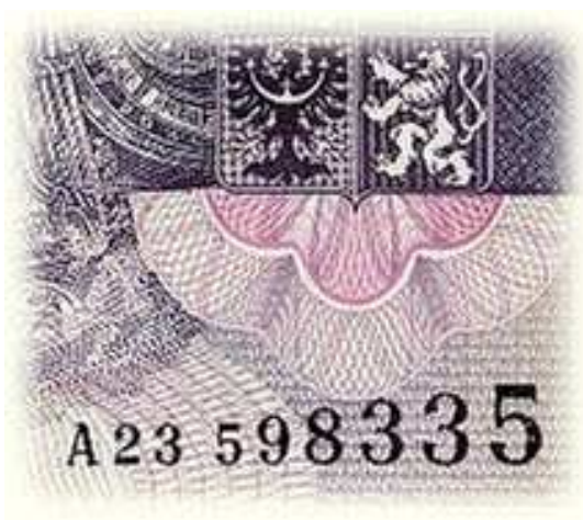
Obr. 1. Číslo bankovky zhotovené „Tiskem z výšky“
