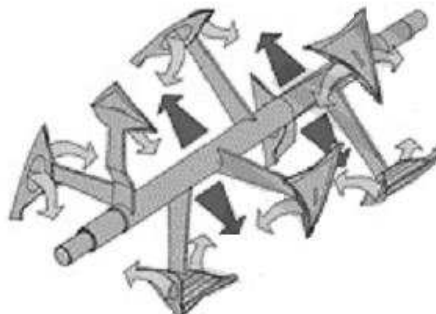
Obr. 15: Směry pohybu materiálu v lopátkovém mísiči [7]
