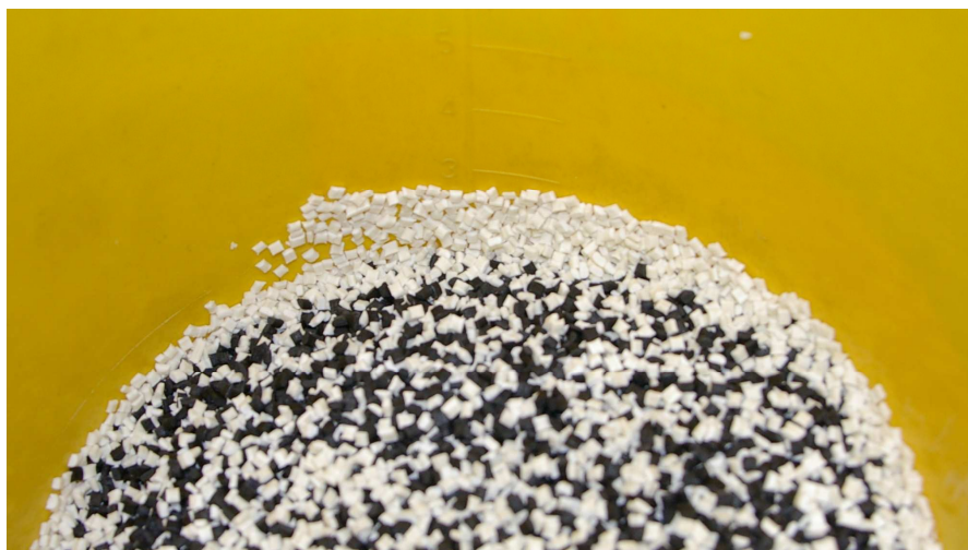
Obr. 39: Ukázka ulpívání bílých granulí na boku kyblíku
