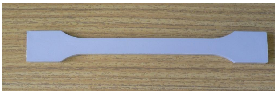
Obrázok 23 - Skúšobná lopatka na ťahovú skúšku
