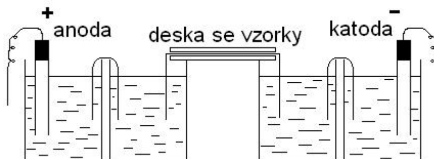
Obr. 6: Základní uspořádání plošné elektroforézy [20]
