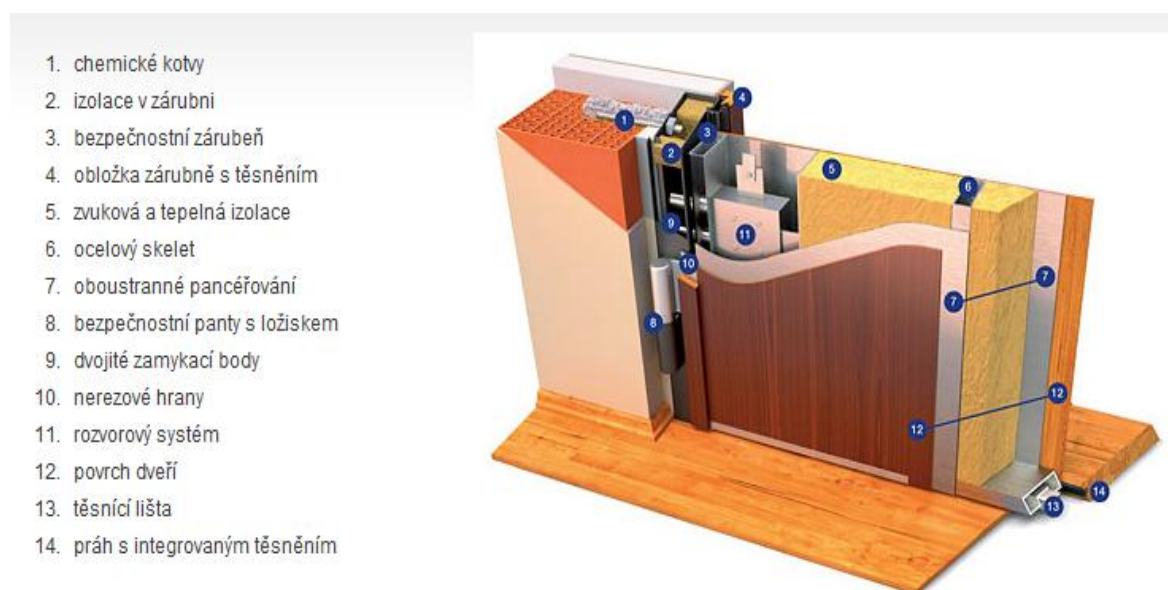
Obr. 12. Popis bezpečnostních dveří NEXT SD 121 [14]
