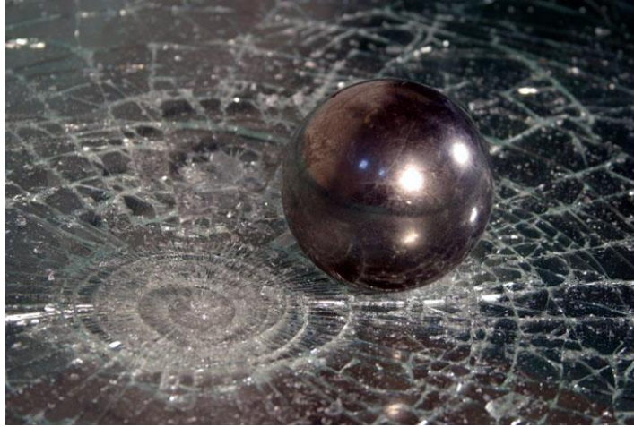
Obr. 19. Rozbité sklo s fólií NEXT SCX [14]
