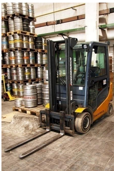
Obrázek 38: Vysokozdvizný vozík využívaný ve skladu
