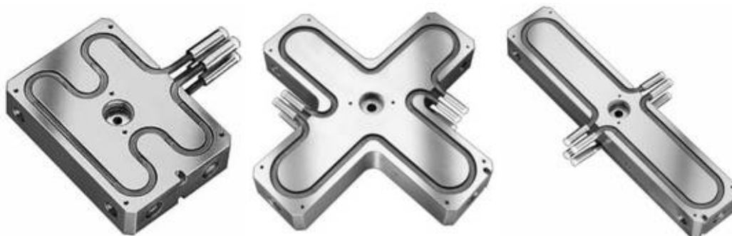
Obr. 29. Příklady vyhřívaných rozvodných bloků [28]
