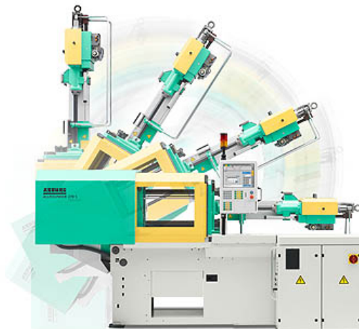
Obr. 7. Překlopná uzavírací jednotka [19]
