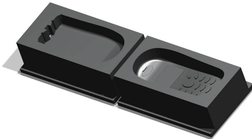
Obr. 34. Dělicí rovina a zaformování výrobku u tvárnice
