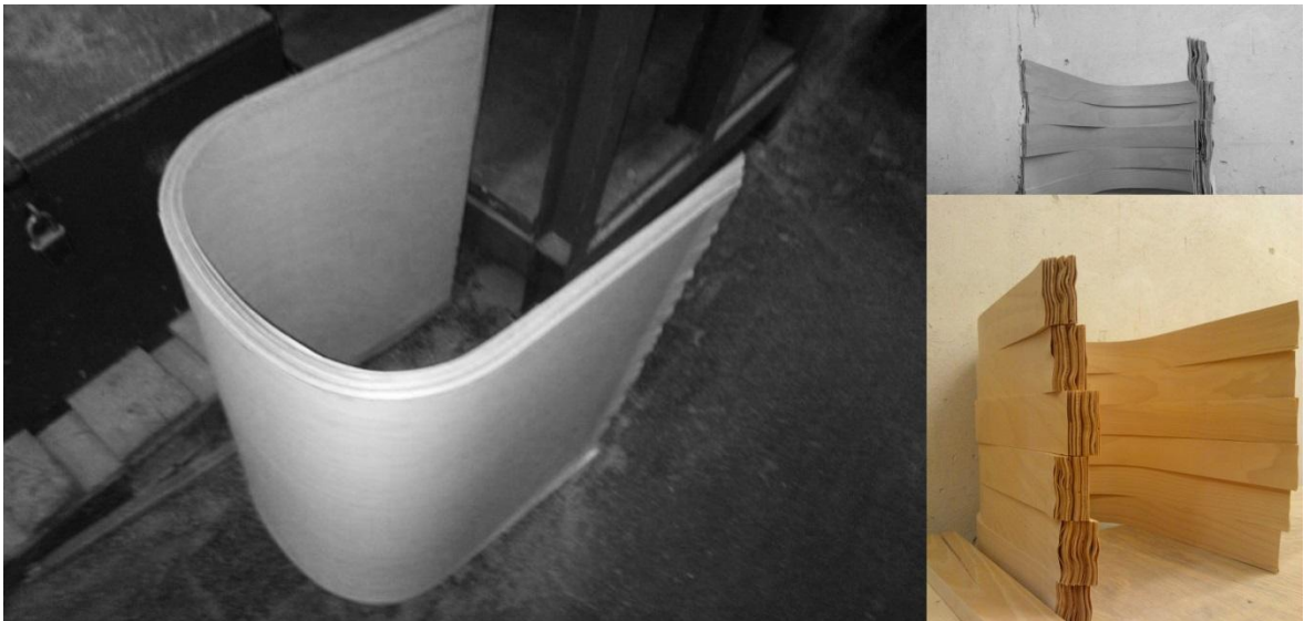
Obr.: 37. Výlisek z výroby a jeho rozdělení s ohledem na výtěžnost materiálu
