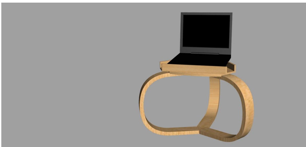
Obr.: 41. Vizualizace podstavy včetně otočené krycí desky sloužící jako podstavec pro notebook
