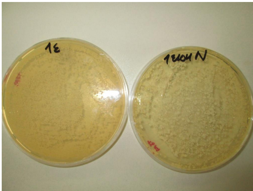
Obr. 24. Počáteční hodnoty (vlevo), inhibiční účinek gelu s obsahem 60 % ethanolu testovaného za praktických podmínek (vpravo)
