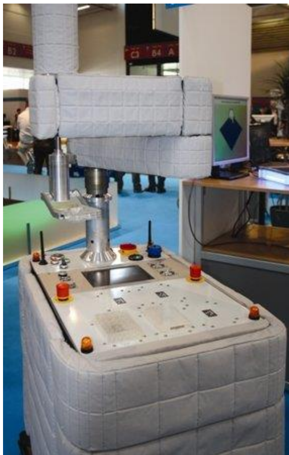
Obr. 12 Povrch stojanu nebo ramene robotu pokrytý „umělou kůží“ [12]
