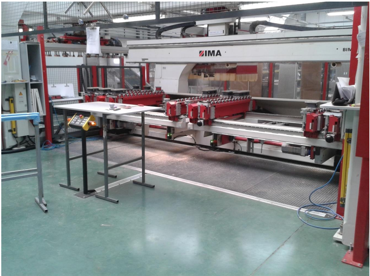
Obr. 16 Světelná závora a nášlapná rohož
