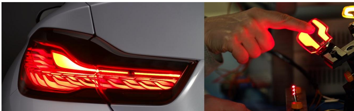
Obr. 7 OLED technologie využitá na konceptu vozu BMW
