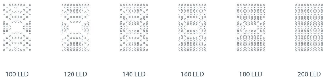
Obr. 9 Možné rozmístění LED diod
