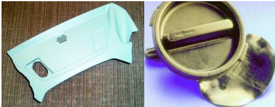
Obr. 8 Nedotečený výstřik (vlevo) a přetok materiálu [12]
