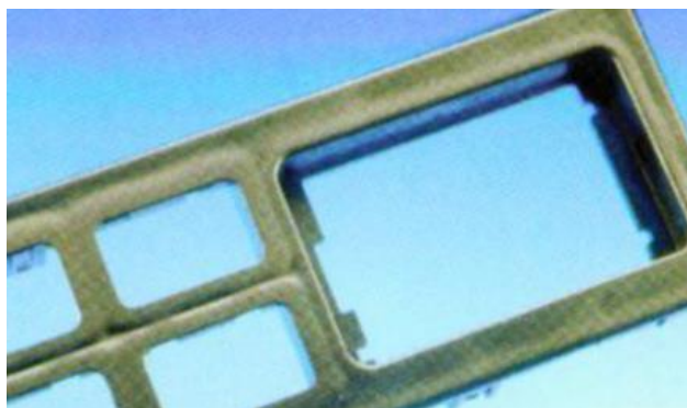
Obr. 9 Propadliny na výrobku [12]
