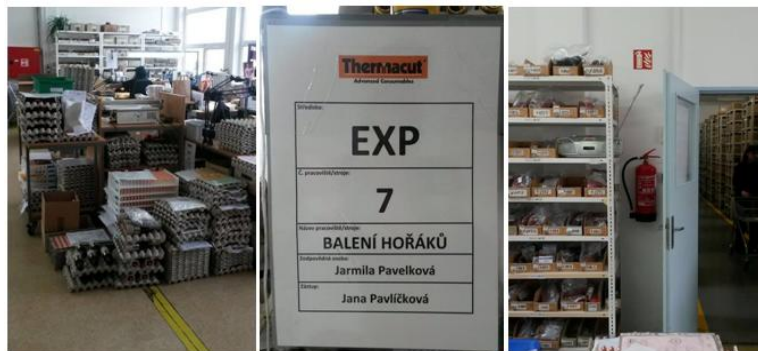
Obr. 15. Zleva – Neúplně volné logistické cesty, označení pracoviště hořáků, značení hasicích prostředků (vlastní zpracování)
