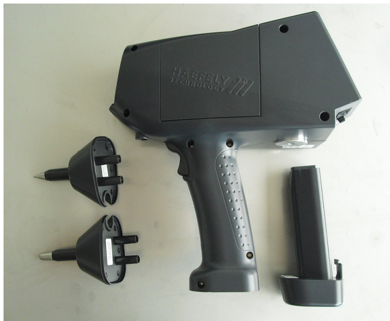
Obr. 19 ESD simulátor ONYX 16 s výměnnými hroty a akumulátorem
