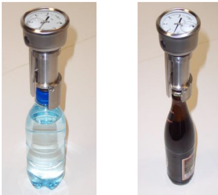
Obrázek 11: Zařízení pro měření sycení manometrickou metodou firmy Steinfurth – PET lahev a skleněná lahev s korunkovým uzávěrem [52]
