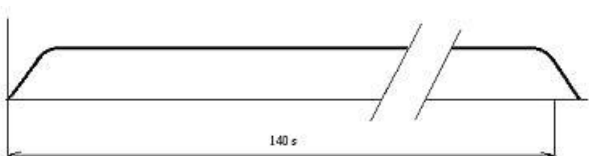
Obrázek 2: Akustická zkouška provozuschopnosti systému varování.[5]
