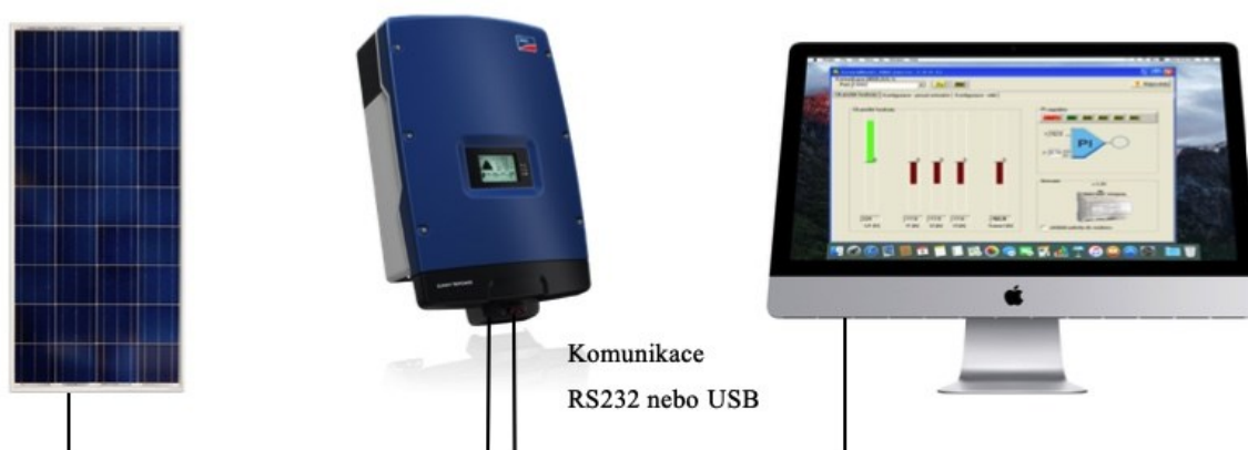
Obr. 29 Lokální monitoring FVE [Svoboda – vlastní]
