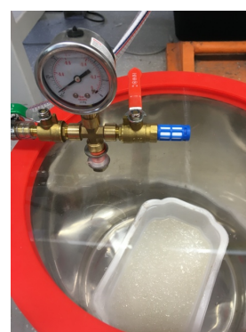
Obr. 141 Tlaková nádoba eliminující vzduchové bubliny
