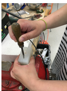
Obr. 143 Dělení formy na dvě části
