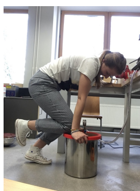
Obr. 141 Tlaková nádoba eliminující vzduchové bubliny
