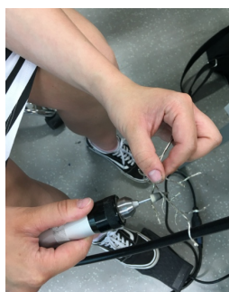
Obr. 154 Leštění ruční vrtací bruskou
