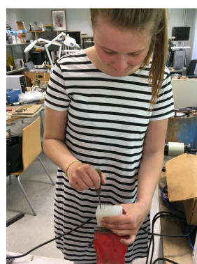
Obr. 143 Dělení formy na dvě části
