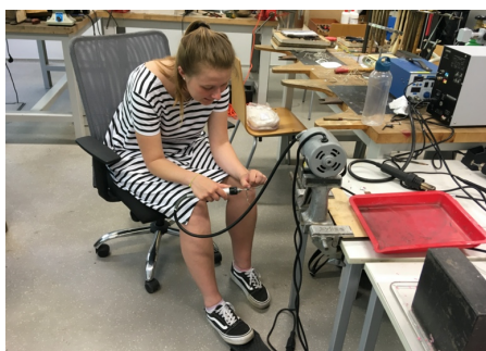
Obr. 154 Leštění ruční vrtací bruskou
