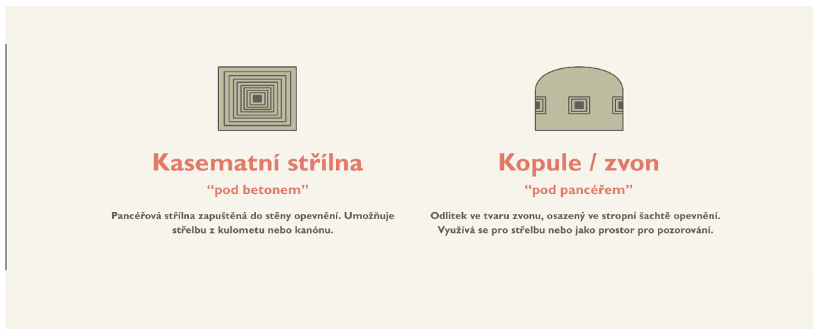
Obrázek 26 Ilustrace kasematní střílny a kopule/zvonu
