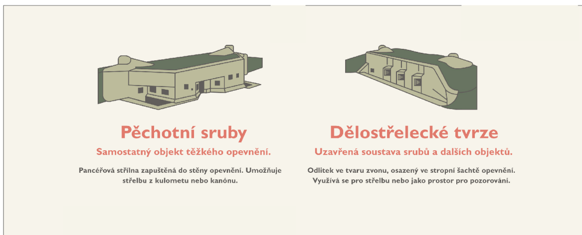
Obrázek 28 Ilustrace objasňující rozdíl mezi pěchotním a dělostřeleckým srubem
