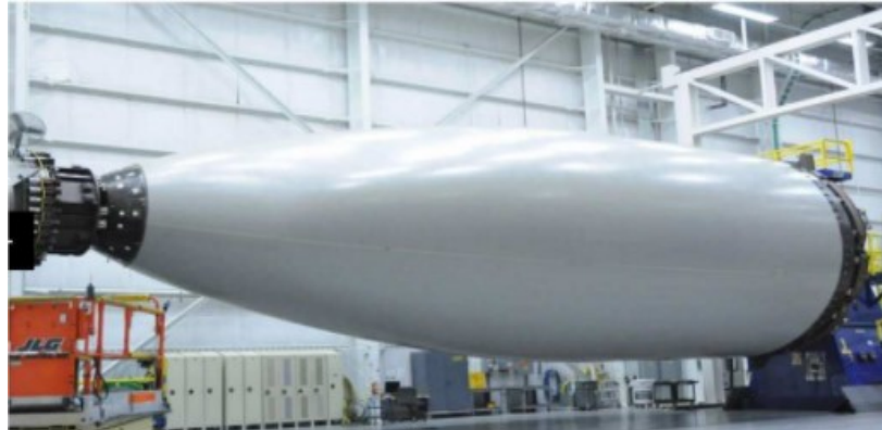
Obrázek 15 Výroba nosu letadla metodou navíjení prepregu [3]
