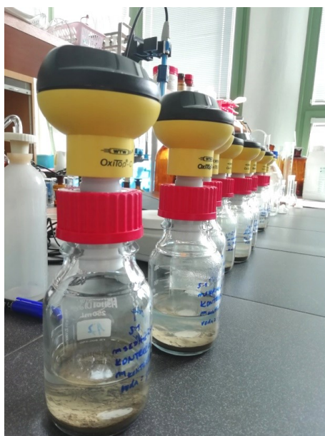
Obrázek 15: Zkušební sestava uzavřeného systému OxiTop®Control.
