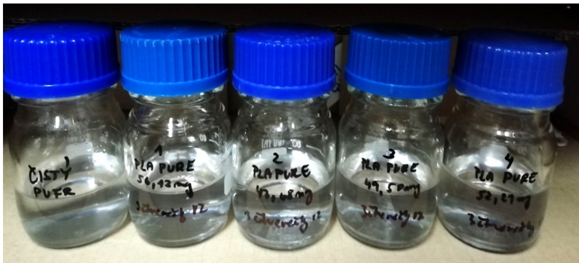
Obrázek 8: Test hydrolyzy - zkušební sestava.
