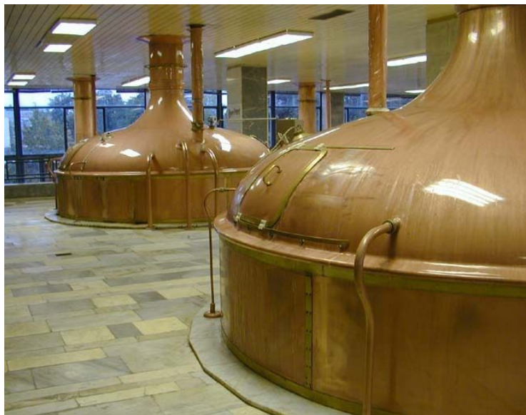
Obrázek 2 Ukázka tradiční měděné rmutovací pánve [9]
