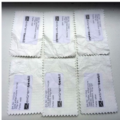
Obrázek 23: (vlevo) Typy Tyveku, lícová strana
