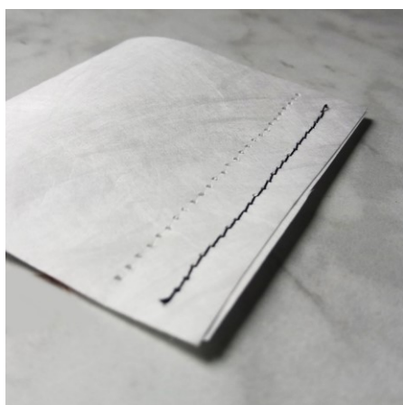
Obrázek 69: (vlevo) Otvory po prošití Tyveku
