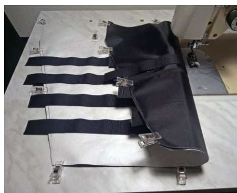
Obrázek 81: (vlevo) Šití PALS pomocí 3D tištěné šablony
