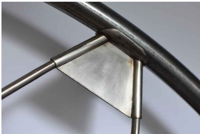
Obr. 45 – konzola zakončující ocelové pruty vzpružené do obruče
