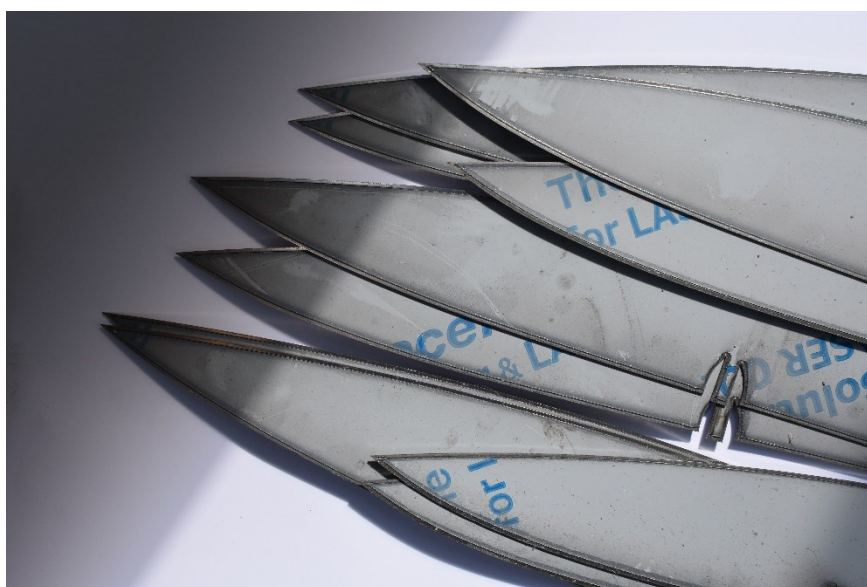
Obr. 46 – detail vyřezaných žeber s krycí folií
