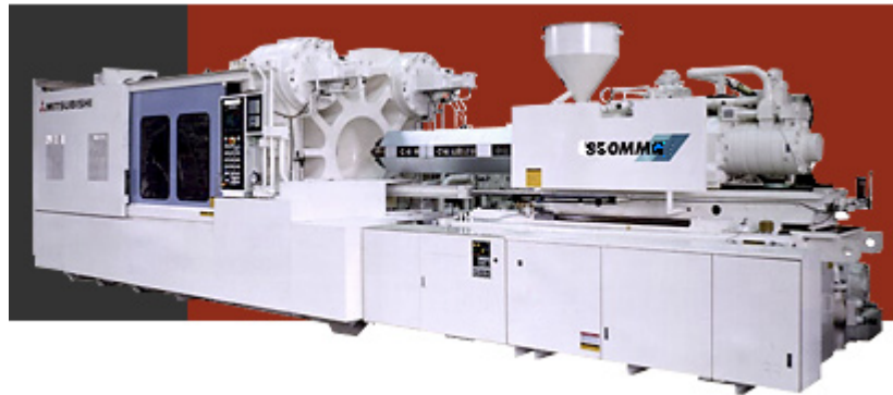
Obr. 23. Vsterkovací stroj Mitsubishi
