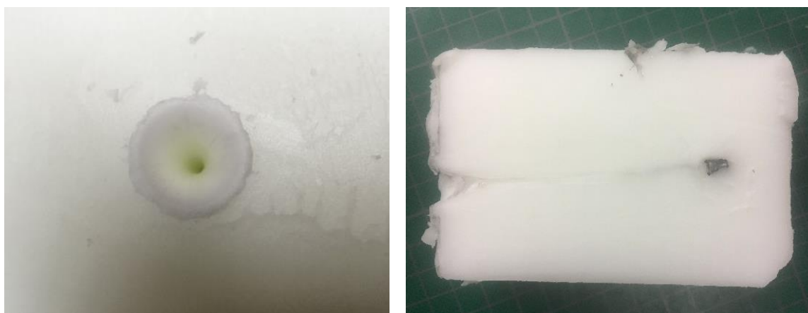
Obrázek 5: Zkušební blok směsi PP 75/25. Vlevo – vstřel na čelní straně bloku, vpravo – podélný řez blokem v místě střelného kanálu se střelou (diabolkou) na konci kanálu (dočasná dutina). Zdroj: vlastní
