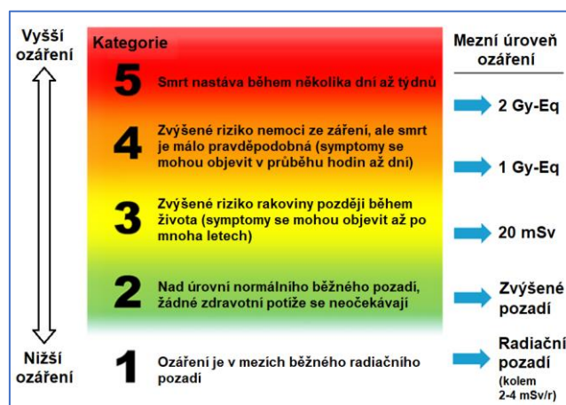
Obrázek 7: Jeden z možných přístupů ke kategorizaci radiačního rizika, který zahrnuje vliv jak stochastických, tak i deterministických účinků (WNA, 2021).
