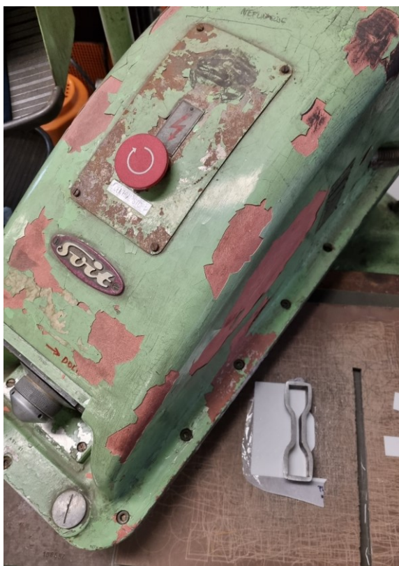
Obr. 16: Vyražení zkušebních tělísek na hydraulickém vysekávacím stroji ZPS 06102 P1 s příslušným nožem.
