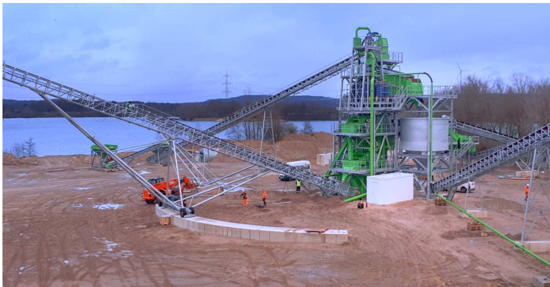
Obrázek 6 Pásový dopravník pro přepravu písku (Foto autor)
