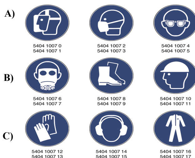
Obrázek 6 Příkazové značky k použití jednotlivých OOPP (A) zleva: Použití ochranného štítu, ochrany dýchacích cest, ochranných brýlí; B) zleva: Použití dýchací masky, ochranné obuvi, ochrany hlavy; C) zleva: Použití ochranných rukavic, ochrany sluchu, celotělové ochrany)
