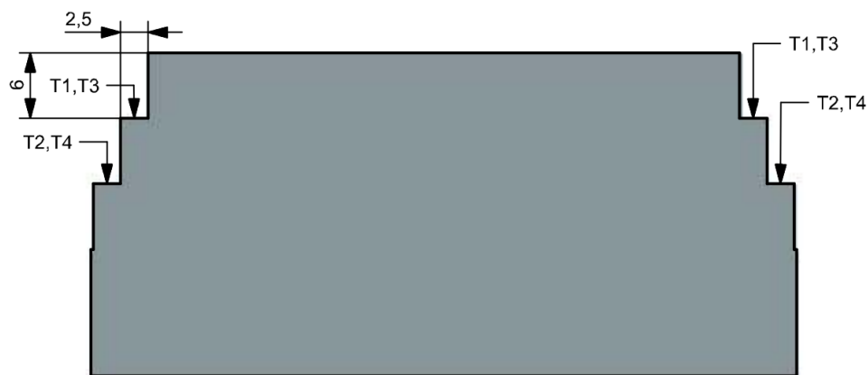
Obr. 72 - Strategie experimentu nástroj T1-T4 – pohled zepředu
