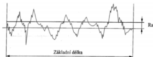
Obr. 39 - Průměrná aritmetická odchylka posuzovaného profilu Ra [26]
