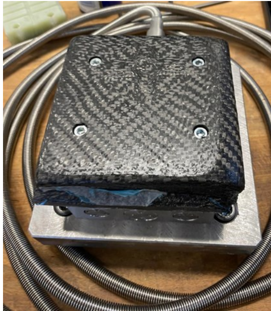
Obr. 62 - Polotovár upnutý v dynamometru
