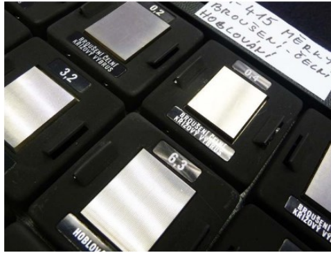
Obr. 42 - Vzorkovnice drsnosti povrchů [32]
