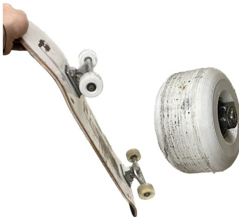
Obrázek 19 Vlevo – upnutá prototypová kolečka na skateboardu, vpravo – detail kolečka.
