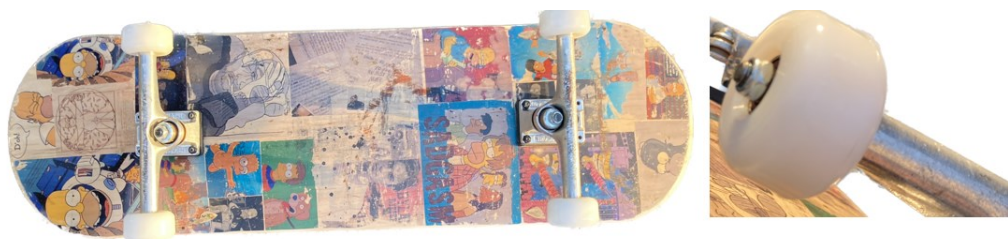
Obrázek 49 Kolečka z TPU upnuté na skateboardu.
