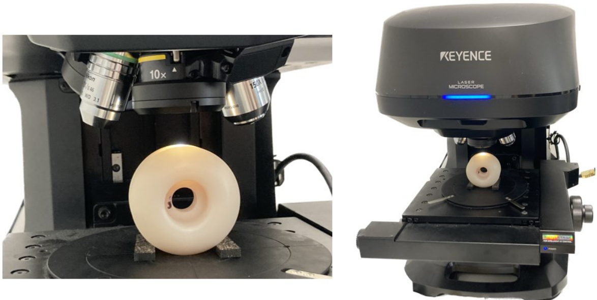
Obrázek 56 Znárodnění měření topologie povrchu kolečka.
