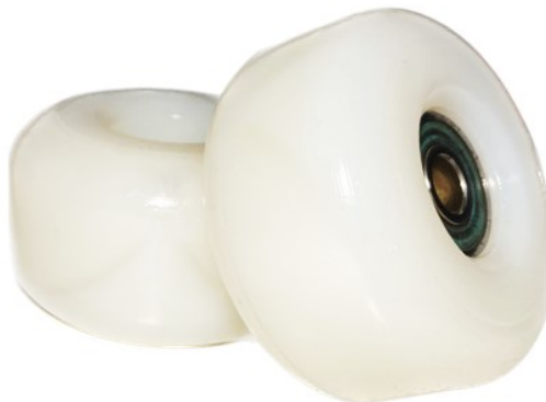
Obrázek 48 Finální podoba koleček po odladění procesu s uloženým ložiskem.
