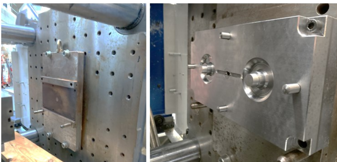
Obrázek 39 Forma upnutá ve stroji.
