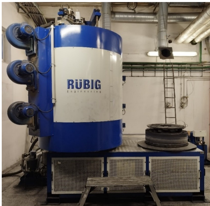
Vakuová nitridační pec RUBIG PN70/121 (interní dokumentace)
