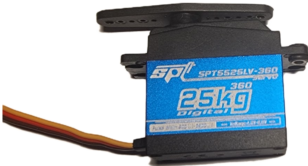
Obrázek 18: Servomotor s nekonečným chodem
