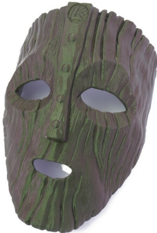
Obrázek 24: 3D tisknutá maska z PLA (23)
