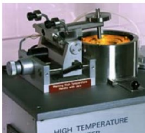
Obr. 31 Princip měření PIN (BALL)-on-DISC [33]
