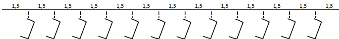
Obrázek 7 – Náčrt zavěšení madel v počtu 12 kusů (vlastní zpracování)
