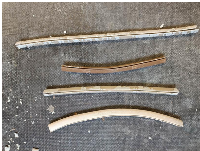
Obrázek 10 – Gumové pásky pro maskování nelakovaných částí (vlastní zpracování)
