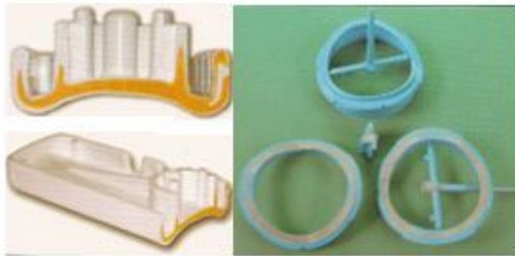
Obr. 29. Zobrazení dílů vzniklých pomocí sendvičového vstřikování
