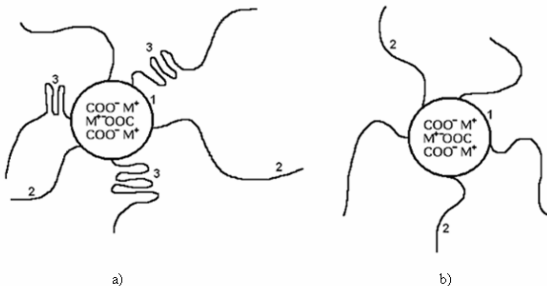
Obr. 8: a) Zobrazení struktury ionomeru v pevném stavu; 1-iontová oblast, 2- amorfní domény, 3- krystalické domény. b) Zobrazení struktury ionomeru v tavenině, bez krystalických domén, které se teplem rozkládají; 1- iontová oblast, 2- amorfní domény [5]
